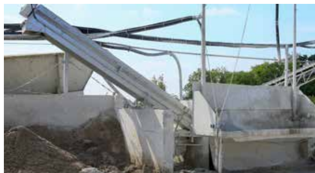
Granulats récupérés en bas à gauche après être passés dans la vis à recycler située sur la droite.
