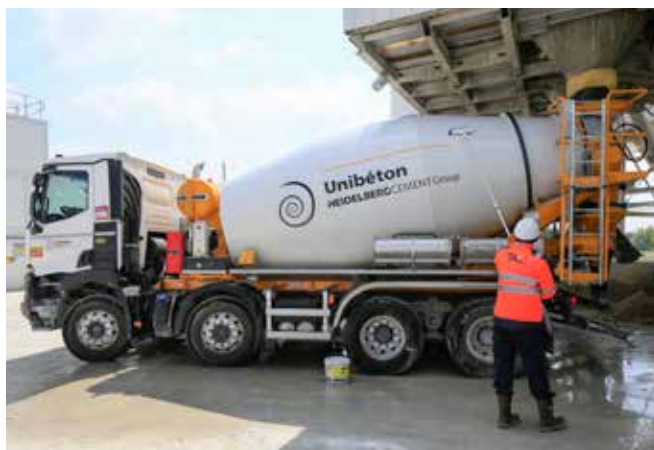
Les eaux de lavage des camions sont également récupérées, comme les eaux de ruissellement.
